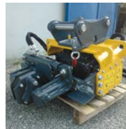
Bagger per installazione pali
